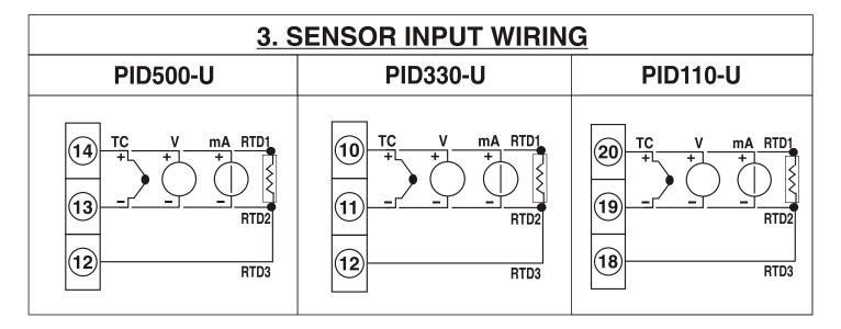
TC - Thermocouple (J, K, T, R, S, C, E, B, N, L, U, W, Platinel II).
